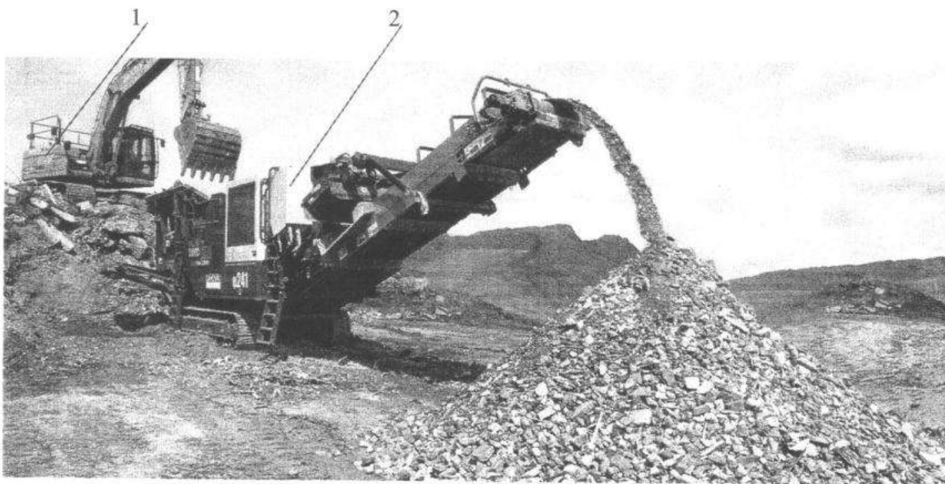
Рисунок 2 Схема осуществления дробления (1-погрузчик фронтальный, 2-мобильная щековая дробилка)
